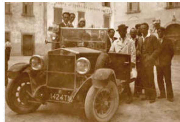
Vezzano 1930: proprio sotto il radiatore è ben visibile il foro entro il quale si inseriva la manovella di accensione.
