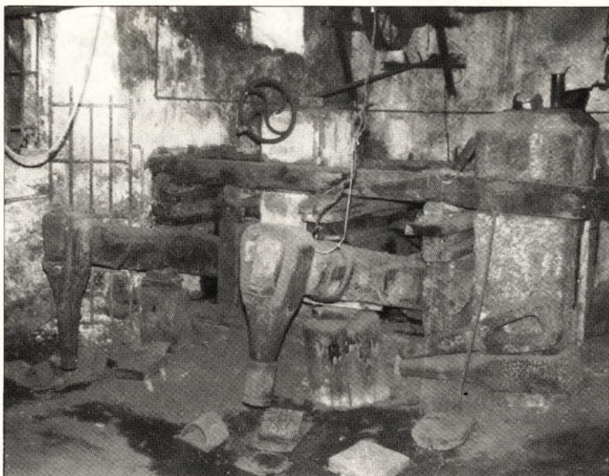
Il maglio mosso dalla ruota idraulica usato per la lavorazione del rame.
