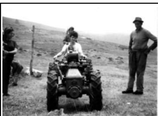
M. Gazza, anni '60 - sul motocoltivatore di Romano Zuccatti si vede in primo piano la ruota intorno a cui si avvolgeva la corda da tirare per l'accensione.
