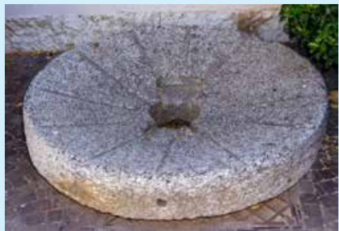
Il palmento inferiore fisso e quello superiore mobile nel quale è ben visibile la sede della nottola e sul profilo uno dei due fori nel quale si infilavano i ganci dell'argano per sollevarlo (M.U.C.G.T.).
