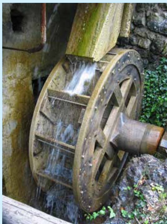
Ruota a cassette alimentata per di sopra.
