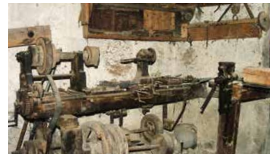
Tornio con alcuni ingranaggi che tramite cinghie trasmettevano il movimento ai vari macchinari presenti nella falegnameria. The lathe that, through many belts, powered the entire carpentry.
