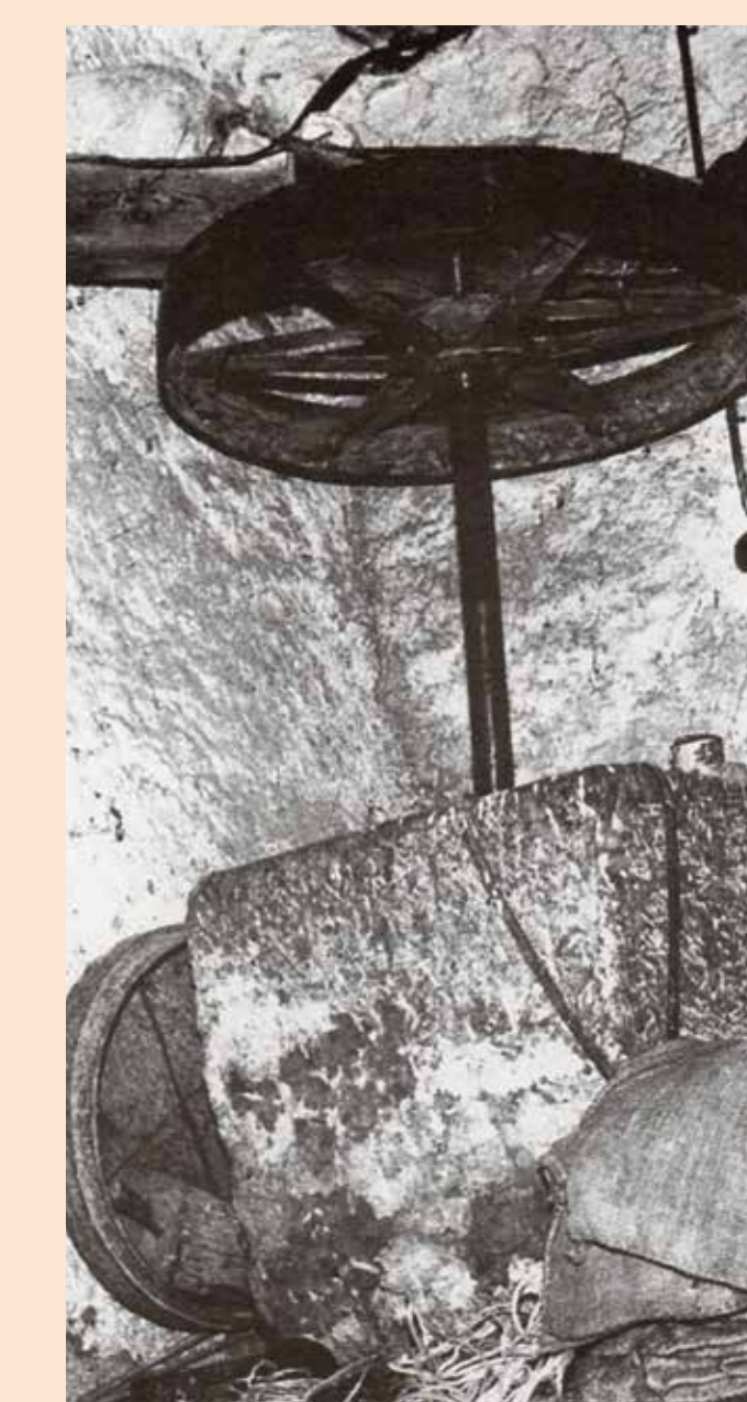
Pestino o pila del mulino Rigotti. Il paletto in ferro, mosso dalla ruota idraulica, permetteva di liberare l'orzo dalla crusca
