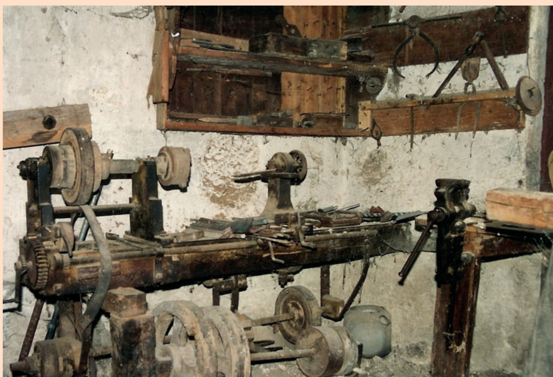
Tornio con alcuni ingranaggi che tramite cinghie trasmettevano il movimento ai vari macchinari presenti nella falegnameria. A lathe with some gears and belts that transmitted the movement to the many machineries of the carpenter's shop.
