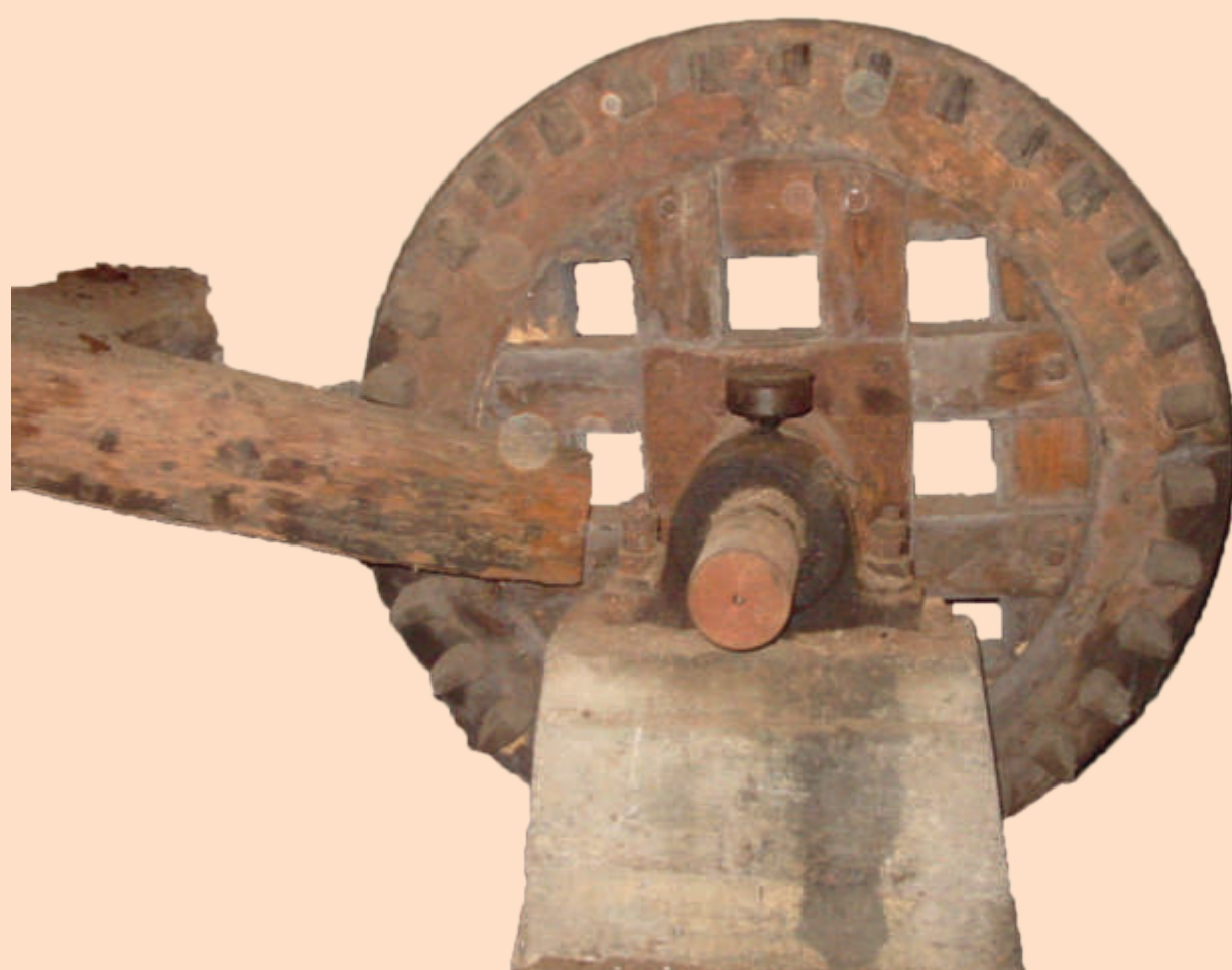
Il lubeccchio, ruota dentata posta sullo stesso asse della ruota idraulica che trasmetteva il moto agli ingranaggi del mulino.
